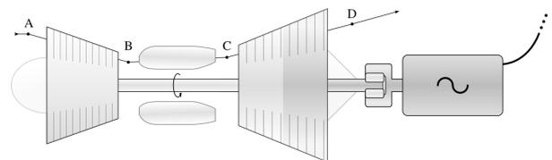
FIGURE 6.21 – Une turbomachine statique, nommée *turbomoteur*, alimentant une génératrice électrique. On tente généralement de détendre le gaz (dans la turbine, entre C et D) jusqu'à pression atmosphérique.
