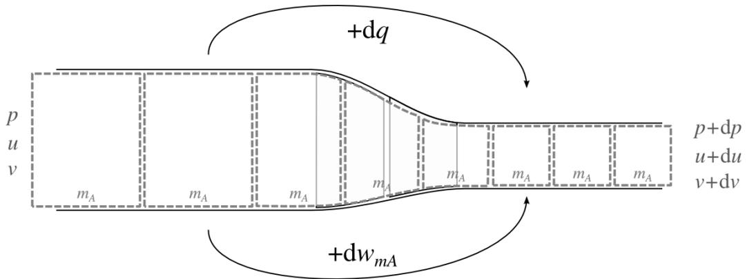
FIGURE 3.4 – Une quantité de masse fixe  $m_A$  circule de gauche à droite à travers un compresseur. Elle est comprimée : ses propriétés passent de  $p$  et  $v$  à  $p + dp$  et  $v + dv$ . Si on se place du point de vue d'un système fermé en transit, le transfert de travail est  $dw_{m_A} = -p dv$ .
