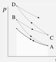
Ainsi, le volume s'élève progressivement sur le diagramme pression-volume : l'excédent de travail investi pendant les compressions, et le défaut de travail récupéré pendant la détente, se traduisent par une augmentation de l'énergie interne du gaz, dont la température augmente continuellement.
