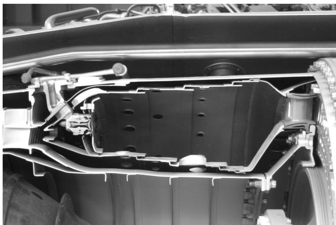
FIGURE 10.10 – Section d'une chambre de combustion annulaire dans laquelle l'écoulement se faisait de gauche à droite. La photo montre une découpe d'un *Rolls-Royce Turbomeca Adour*, petit turboréacteur conçu en 1968.
