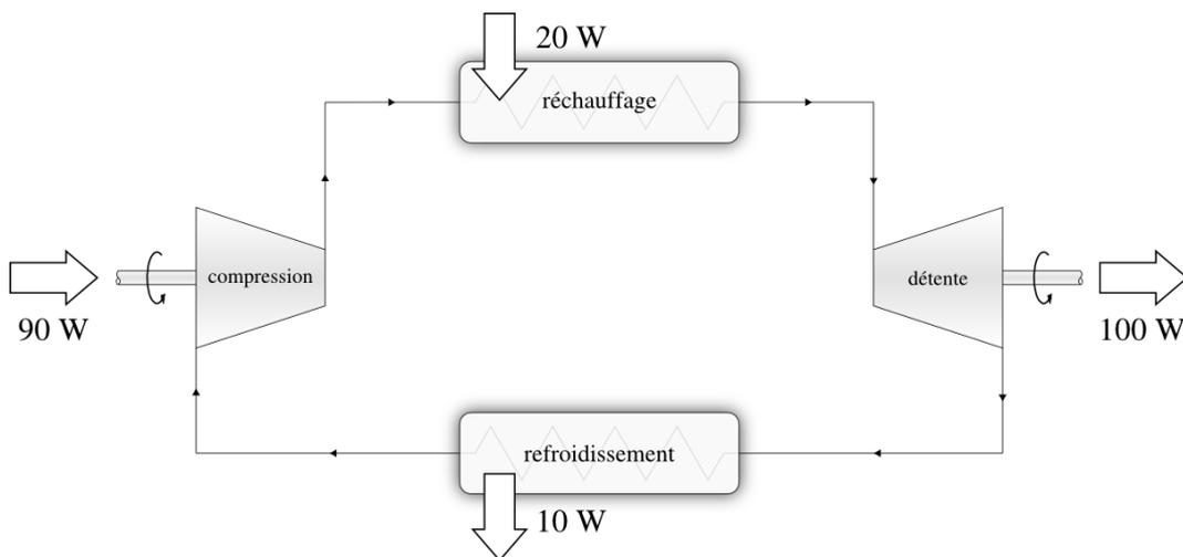
FIGURE 10.1 – Le cycle d'un moteur (hypothétique) à faible marge de travail. La puissance développée est de  $\dot{W}_{\text{net}} = \dot{W}_{\text{compression}} + \dot{W}_{\text{détente}} = +90 + (-100) = -10 \text{ W}$ , et le rendement  $\eta_{\text{moteur}} = -\frac{\dot{W}_{\text{net}}}{\dot{Q}_{\text{in}}} = -\frac{-10}{20} = 50 \%$ .
