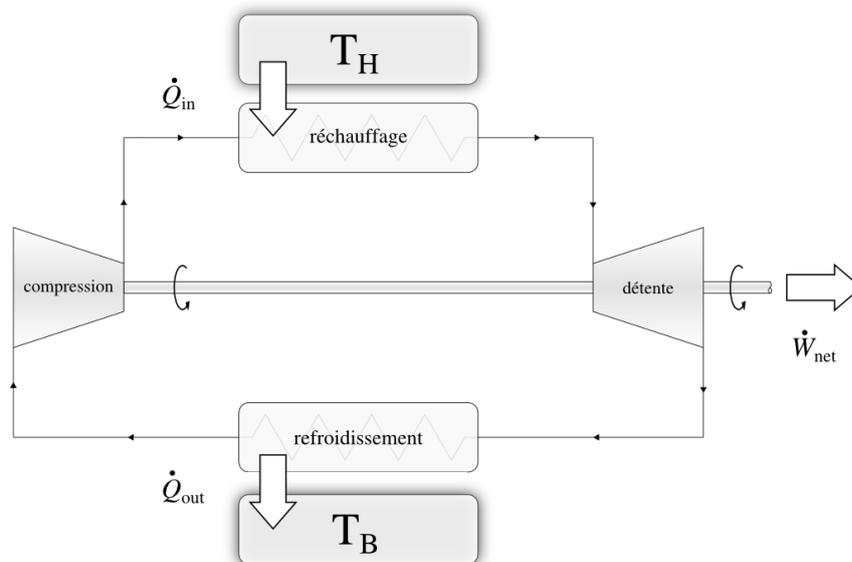
FIGURE 6.4 – Cycle thermodynamique moteur, pour lequel le compresseur et la turbine sont couplés mécaniquement. Comme la turbine fournit une puissance  $\dot{W}_{\text{out}}$  supérieure à celle consommée par le compresseur ( $\dot{W}_{\text{in}}$ ), elle est capable non seulement de l'entraîner mais aussi de fournir un excédent  $\dot{W}_{\text{net}}$  vers l'extérieur.
