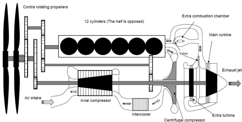
FIGURE 10.27 – Schéma de principe du circuit thermodynamique du *Napier Nomad I*. L'arbre de la turbomachine et celui du Diesel alimentent chacun une hélice. Pourtant, les deux ensembles sont montés en série : l'air circule d'abord dans les compresseurs, puis dans les cylindres, puis dans la ou les turbines. La puissance du moteur, comme c'est l'usage en 1950, est contrôlée avec une seule manette de commande mécanique !
