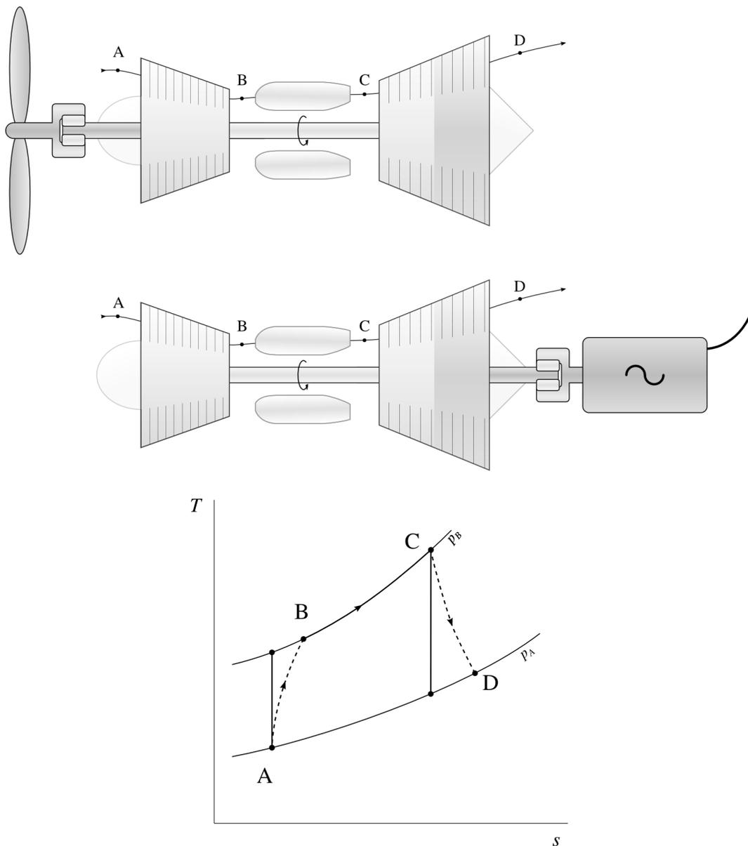
FIGURE 10.18 – Schémas de principe et diagramme température-entropie d'un turbojet (haut) et d'un turbomoteur (bas). La puissance extraite de la turbine dépasse celle consommée par le compresseur et est utilisée pour alimenter l'hélice ou bien une génératrice.
