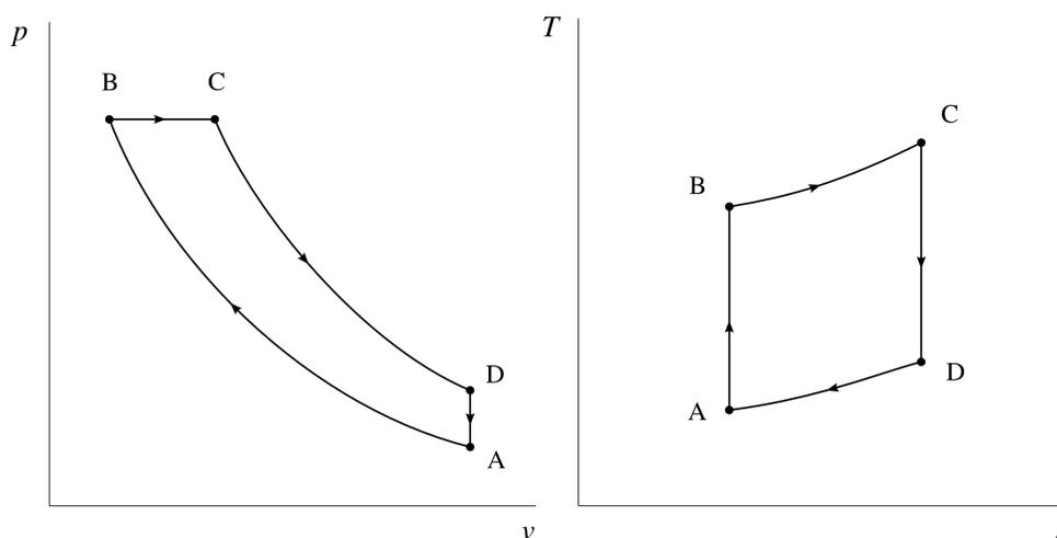
FIGURE 10.4 – Cycle théorique de Diesel représenté sur des diagrammes pression-volume et température-entropie. Ces graphiques représentent le trajet idéal, sans irréversibilité de compression ou détente.
