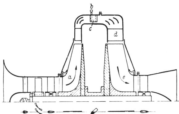
FIGURE 9.25 – Schéma de coupe du *Heinkel He S-1*, premier prototype testé par Hans von Ohain en 1937. Le compresseur est constitué d'un étage axial et d'un étage centrifuge ; la turbine est centripète. Il n'y a qu'une pièce mobile et sa vitesse est uniforme.
