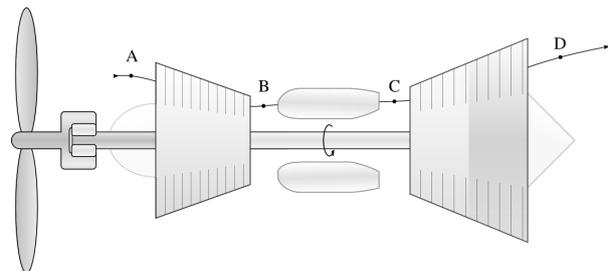
FIGURE 10.33 – Agencement interne de principe d'un turbopropulseur.
