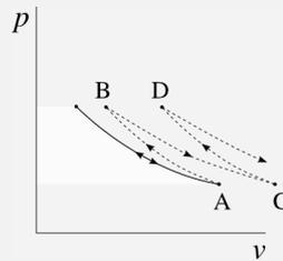
Ainsi, les propriétés se décalent progressivement sur le diagramme pression-volume. Si les évolutions ne se font pas lentement, le compresseur demande plus d'énergie que la turbine est capable de prélever au retour. Cet excédent d'énergie est absorbé par l'air, ce qui augmente son énergie interne et sa température.
