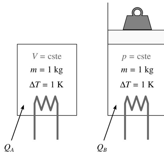
FIGURE 4.3 – Définitions des chaleurs massiques. À gauche, le volume est fixé et la capacité calorifique massique sera  $c_v$ . À droite, la pression est constante et la capacité sera  $c_p$ .
