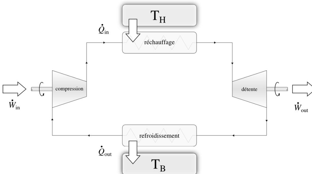
FIGURE 6.2 – Cycle thermodynamique moteur. Le fluide absorbe de la chaleur fournie à haute température  $T_H$ . la puissance de compression est plus faible que la puissance à la détente : la puissance nette sous forme de travail  $W_{net} = \dot{W}_{in} + \dot{W}_{out}$  est négative.
