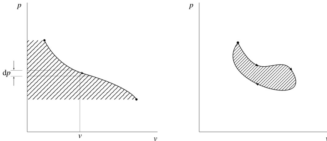
FIGURE 3.7 – Travail mesuré dans un système ouvert, pendant une évolution réversible. L'intégrale de  $v dp$  est visualisée par l'aire à gauche de la courbe. Si le fluide revient à son état initial (ayant effectué un cycle), le travail développé est visualisé par l'aire incluse dans la courbe. Dans ce cas, la quantification est identique en système fermé et ouvert.
