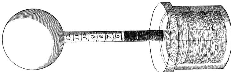
FIGURE 1.5 – Thermomètre à air du début du XVII<sup>e</sup> siècle. La boule est remplie de gaz dont le volume varie avec sa température, repoussant l'eau du réservoir en dessous dont la surface est à pression atmosphérique. Le liquide peut être coloré, et ses variations de hauteur sont mesurées au moyen d'une graduation. La pression atmosphérique variant avec les conditions météorologiques, elle affecte les mesures : c'est, en quelque sorte, un baro-thermomètre.
