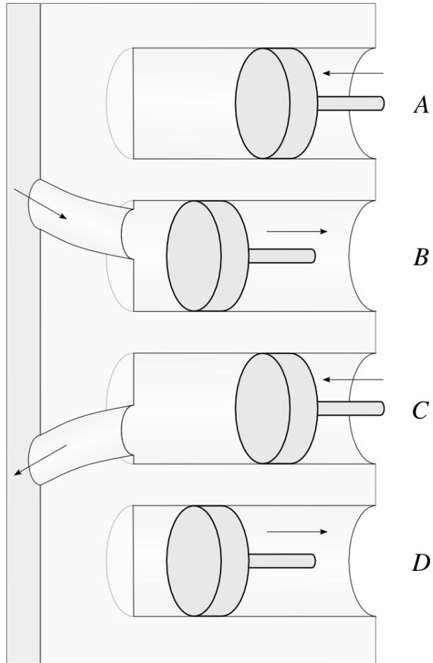
FIGURE 2.22 – Représentation schématique du fonctionnement d'un moteur à quatre cylindres. Les pistons A et C sont en remontée, et les pistons B et D sont en descente. Ils sont tous les quatre liés au même axe moteur, non représenté ici.
