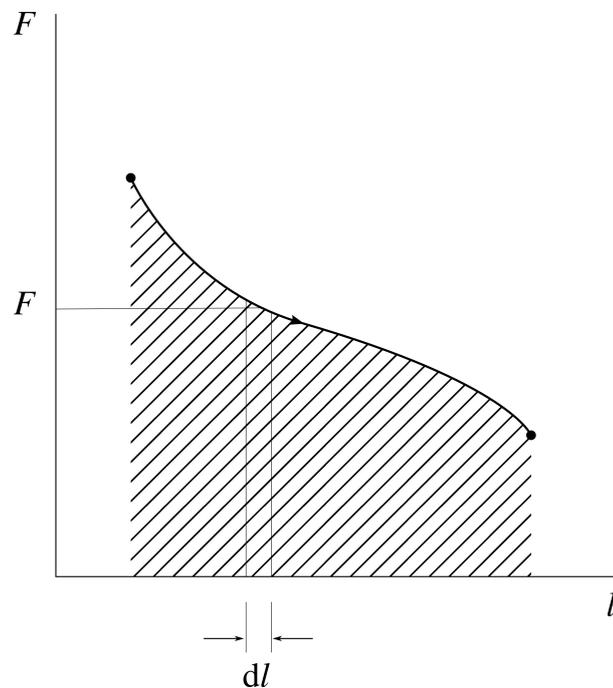
FIGURE 1.3 – Sur un diagramme force-distance, le travail fourni par un objet peut être visualisé avec l'aire sous la courbe. Dans le cas montré ici, l'objet voit sa longueur  $l$  augmenter, et le travail sera négatif (fourni par l'objet).
