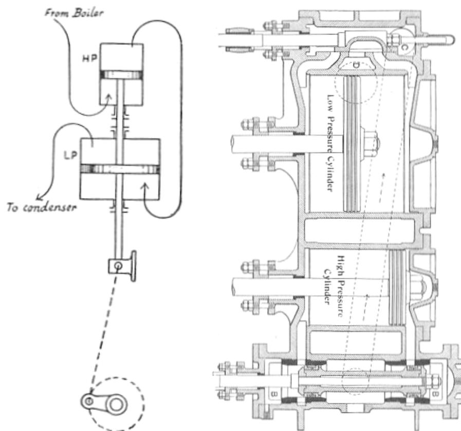
FIGURE 2.18 – Différents systèmes compound à vapeur.
