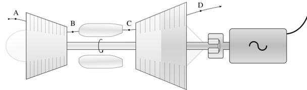
FIGURE 3.11 – Schéma de principe d'une turbomachine génératrice d'électricité.
