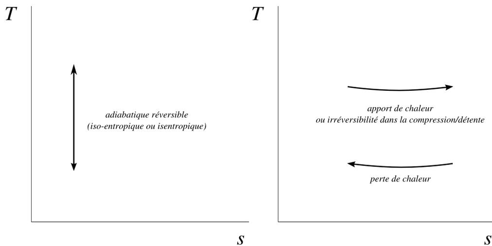
FIGURE 8.4 – Évolutions élémentaires sur les diagrammes température-entropie.
