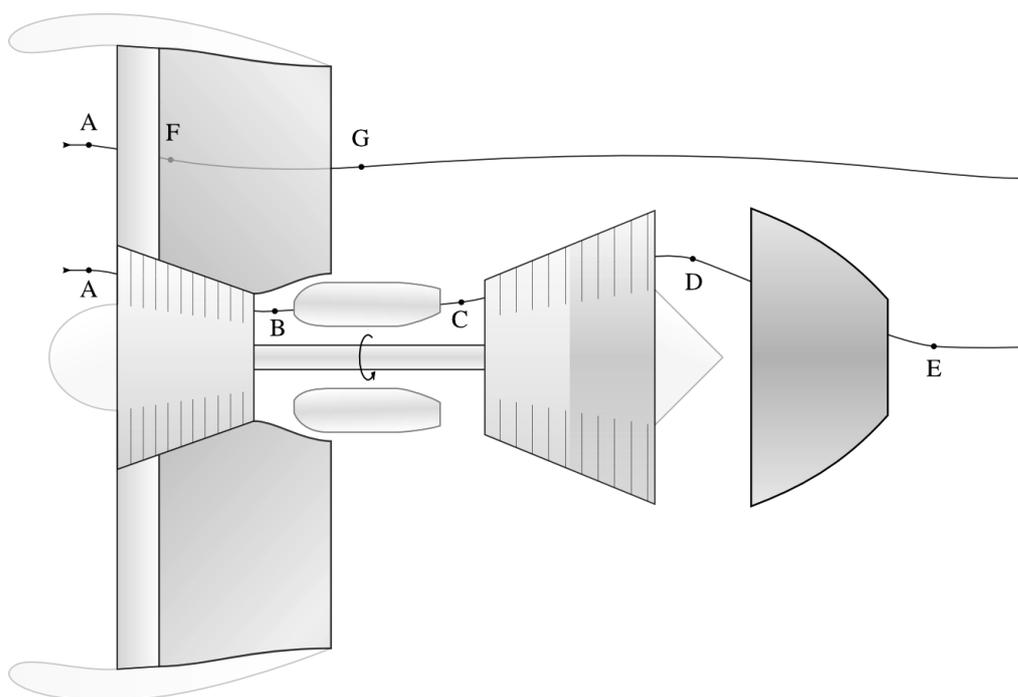
FIGURE 10.19 – Schéma de principe d'un turbofan. Le circuit central du moteur ( $A \rightarrow E$ ) alimente mécaniquement la soufflante, qui permet au circuit externe ( $A \rightarrow G$ ) de fournir la majorité de la poussée.
