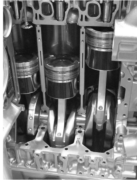
FIGURE 2.21 – Pistons et cylindres d'un moteur automobile décapoté.
