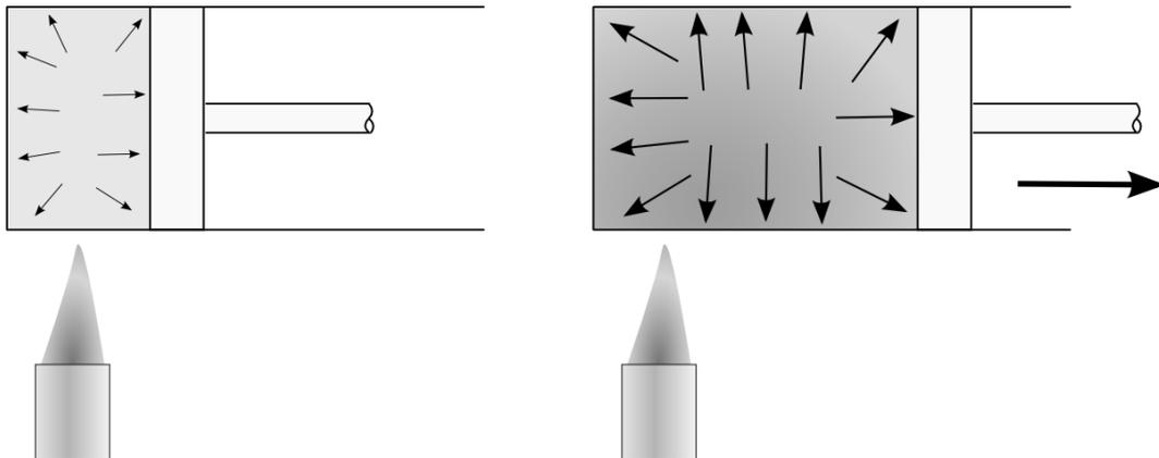
FIGURE 2.2 – Principe de fonctionnement d'un moteur. Lorsque l'on fournit de la chaleur à un fluide dans un réservoir fermé, celui-ci augmente les forces qu'il exerce sur les parois du réservoir. En laissant le réservoir se déformer, on fait effectuer un travail au fluide.
