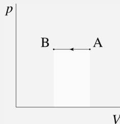
Nous partons de l'équation 2/9 :  $W_{A \rightarrow B} = - \int_A^B p \, dV = -p_{\text{cste.}} \int_A^B dV = p_{\text{cste.}} [V]_{V_A}^{V_B} = -10^5 (1 \cdot 10^{-3} - 2 \cdot 10^{-3}) = +100$  J.
