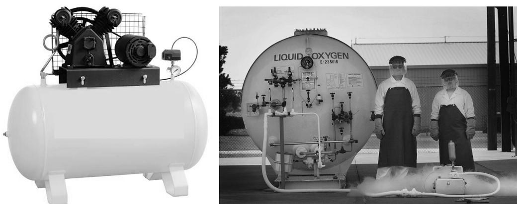
FIGURE 1.4 – À gauche : lorsqu’il est comprimé dans un compresseur, l’air perd de la chaleur au travers des parois et des aubes des cylindres ; et pourtant sa température augmente. À droite : à l’inverse, lorsqu’il est détendu dans une soupape, l’oxygène liquide reçoit de la chaleur de l’atmosphère (comme le mettent en évidence la condensation et le gel de l’eau atmosphérique sur les tuyaux) ; et pourtant sa température chute.
