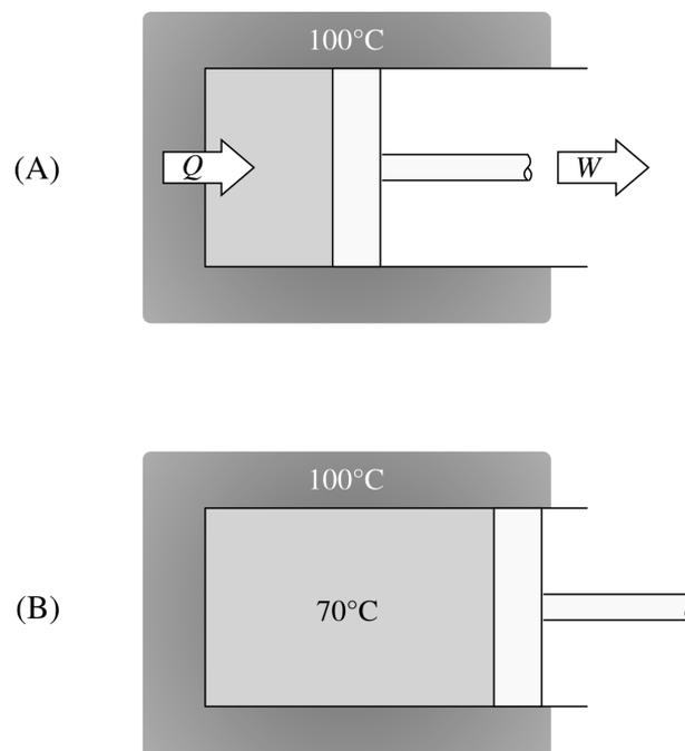
FIGURE 7.1 – Production d'un travail avec de la chaleur issue d'un corps à  $100\text{ }^{\circ}\text{C}$  : le transfert de chaleur permet la production d'un travail mais il provoque également une augmentation de température du fluide.
