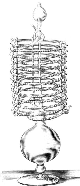
FIGURE 1.7 – Thermomètre de Florence du milieu du XVII<sup>e</sup> siècle. Cette fois, c'est le liquide, contenu dans la boule inférieure, qui se contracte et se détend avec la température. Ses variations de volume sont telles qu'un long tube de verre soufflé en spirale est nécessaire pour les mesurer.
