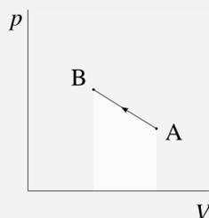
Encore une fois nous partons de l'équation 2/9 :  $W_{A \rightarrow B} = - \int_A^B p \, dV = - \int_A^B (7 \cdot 10^5 - 2 \cdot 10^8 V) \, dV = - \left[ 7 \cdot 10^5 V - \frac{1}{2} \cdot 10^8 V^2 \right]_{V_A}^{V_B} = -(700 - 100 - 1400 + 400) = +400$  J (positif : travail reçu par le système).
