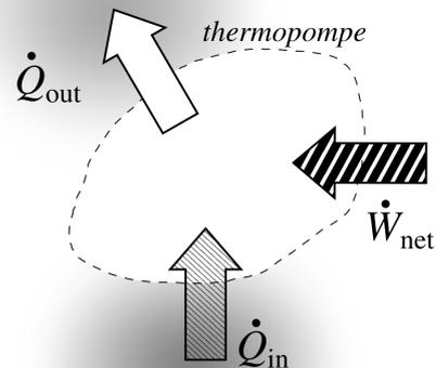
FIGURE 6.13 – Transferts énergétiques associés à une pompe à chaleur. On souhaite obtenir un grand transfert  $\dot{Q}_{\text{out}}$  (résultat) à partir du transfert  $\dot{W}_{\text{net}}$  (coût).
