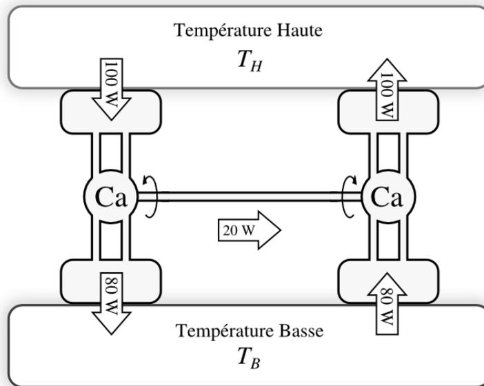
FIGURE 7.6 – Deux machines de Carnot, un moteur (à gauche) et un réfrigérateur (à droite). La première alimente la seconde, et comme elles sont réversibles, les flux de chaleur sont compensés.
