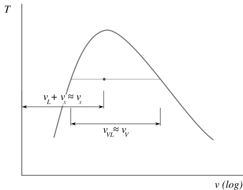
FIGURE 5.13 – Approximations utilisées dans le calcul du volume occupé par un mélange liquide-vapeur. Il faut bien noter que l'échelle en abscisse est logarithmique :  $v_L$  est en général plusieurs centaines de fois plus petit que  $v_V$ , et l'approximation n'est pas mise en valeur graphiquement.
