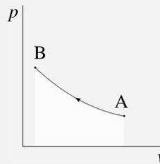
Il nous faut d'abord calculer la valeur de  $k$  pour connaître quantitativement la relation entre  $p$  et  $v$ . Nous l'obtenons avec les conditions initiales :  $k = p_A v_A^{1,2} = 10^5 \times 1^{1,2} = 10^5 \text{ u.SI}$ .
