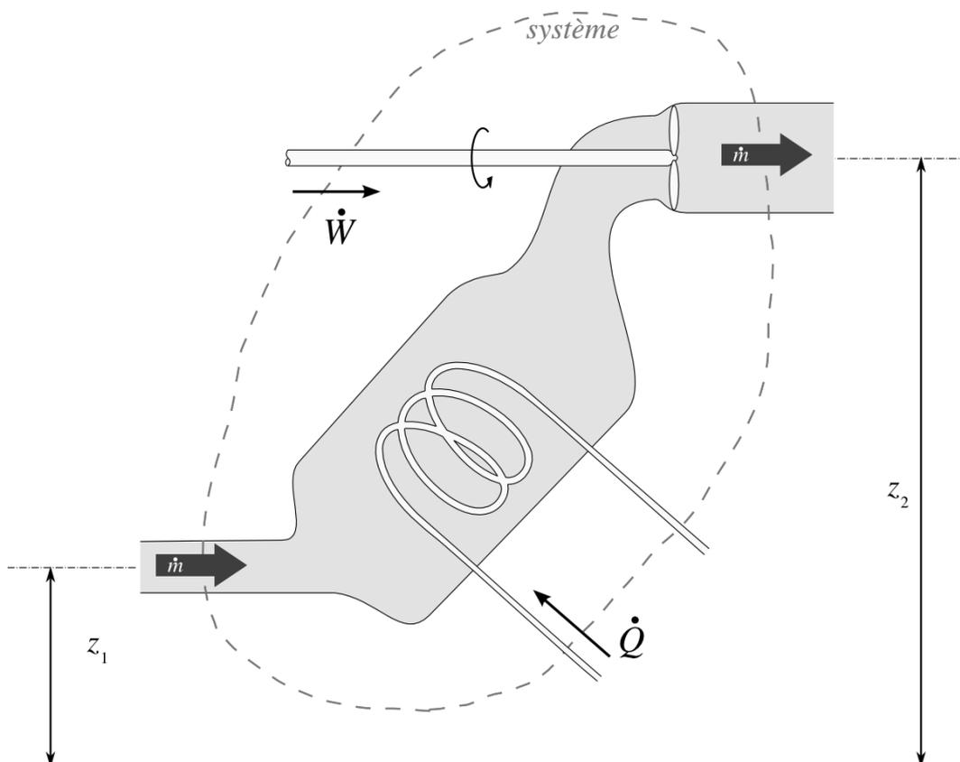
FIGURE 3.3 – Système ouvert arbitraire. Le système (dont les frontières sont en pointillés, en rouge) est traversé de gauche à droite par le fluide qui circule avec un débit de masse  $\dot{m}$  constant. Il reçoit une puissance  $\dot{W}_{1 \rightarrow 2}$  sous forme de travail et une puissance  $\dot{Q}_{1 \rightarrow 2}$  sous forme de chaleur.
