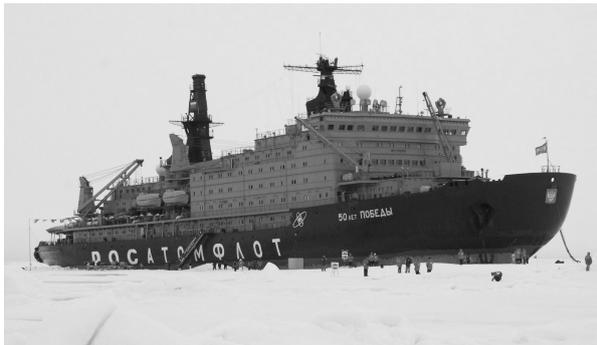
FIGURE 9.28 – Le 50 Let Podedby, brise-glace de  $25\,000\text{ t}$  à propulsion nucléo-turbo-électrique (deux réacteurs de  $171\text{ MW}_{\text{chaleur}}$ , trois moteurs de  $17,6\text{ MW}_{\text{méch.}}$ ). Sa construction a débuté en 1989 mais il n'est entré en service qu'en 2007.
