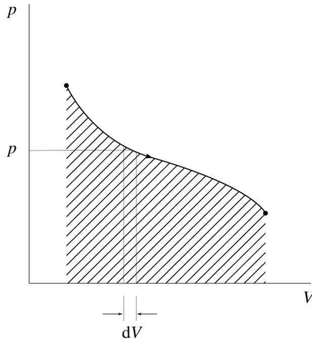
FIGURE 2.6 – Diagramme pression-volume d'un système fermé modélisé par un ressort. Dans le cas représenté, le volume augmente (le piston s'éloigne). La grandeur  $dV$  sera constamment positive, et le travail sera négatif : le système perd de l'énergie au profit du piston. Cette figure représente le même phénomène que celui de la figure 1.3 p.9, avec des grandeurs physiques différentes.
