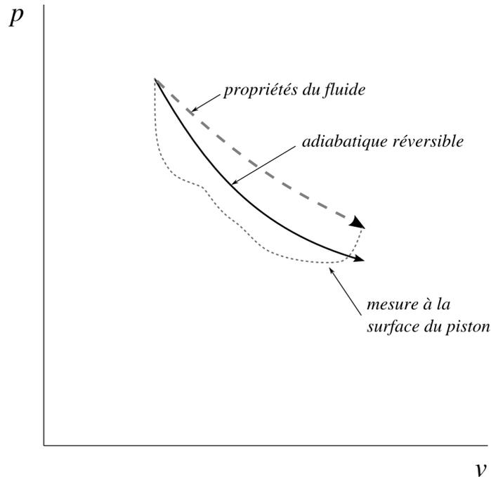
FIGURE 2.15 – Détente irréversible adiabatique sur un diagramme pression-volume. Le travail reçu par le piston est plus faible qu'il ne l'aurait été avec un mouvement lent. Le trajet suivi par le fluide est représenté en pointillés (la pression n'étant pas homogène pendant le mouvement).
