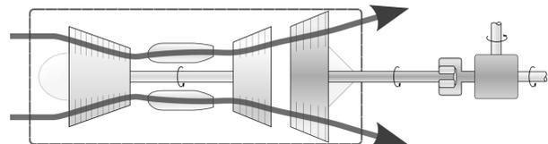
FIGURE 1.14 – Un hélicoptère Sikorsky S-76B, équipé de deux turbomoteurs P&WC PT-6B de  $980\text{ ch}$  chacun. Le trajet de l'air dans les moteurs est représenté dans un schéma de principe. Nous étudions ces moteurs plus en détail au chapitre 10 (cycles moteurs à gaz).
