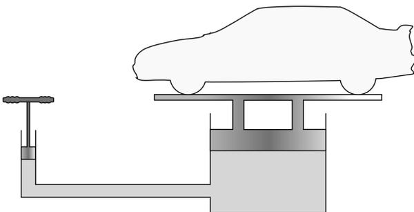
FIGURE 1.11 – Schéma de principe d'un cric hydraulique.
