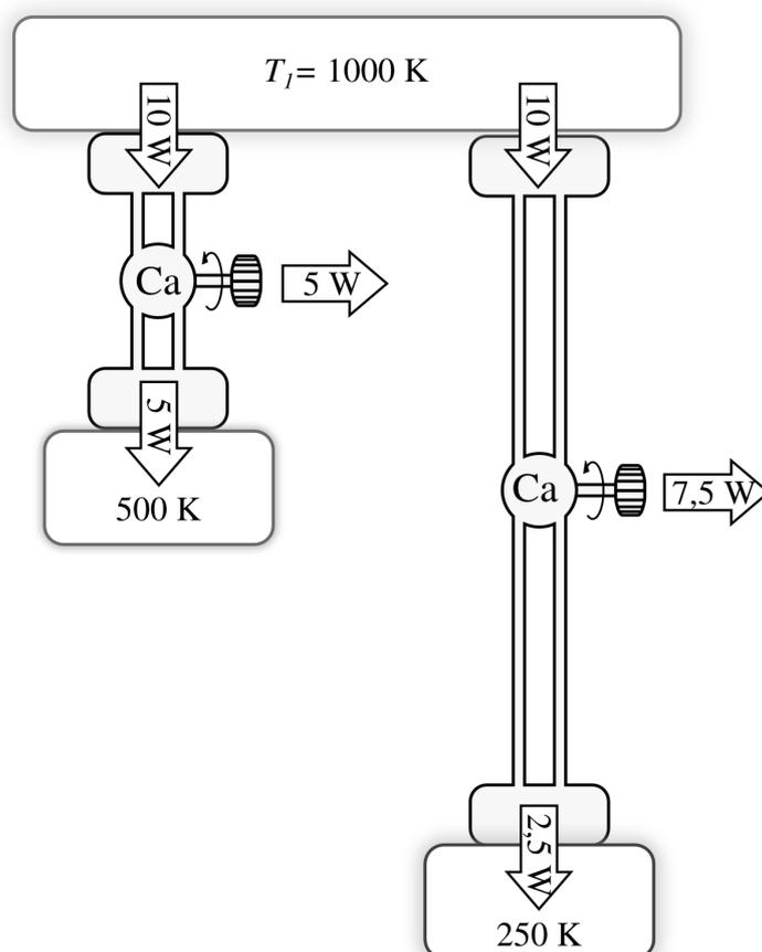
FIGURE 7.12 – Expérience permettant d'illustrer l'échelle de température absolue proposée par William Thomson. Un moteur de Carnot fonctionnant entre 1 000 K et 500 K rejette  $\frac{1000}{500} = 50\%$  de la chaleur qu'il reçoit. Si la température basse est quatre fois plus faible, ce rejet est quatre fois plus faible ( $\frac{1000}{250}$ ) que la chaleur reçue.
