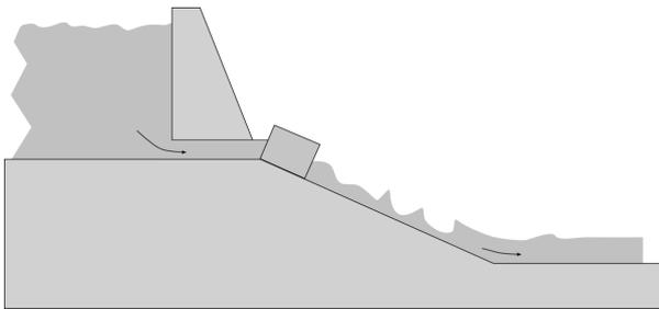
FIGURE 3.14 – Schéma de principe d'une installation génératrice hydraulique.
