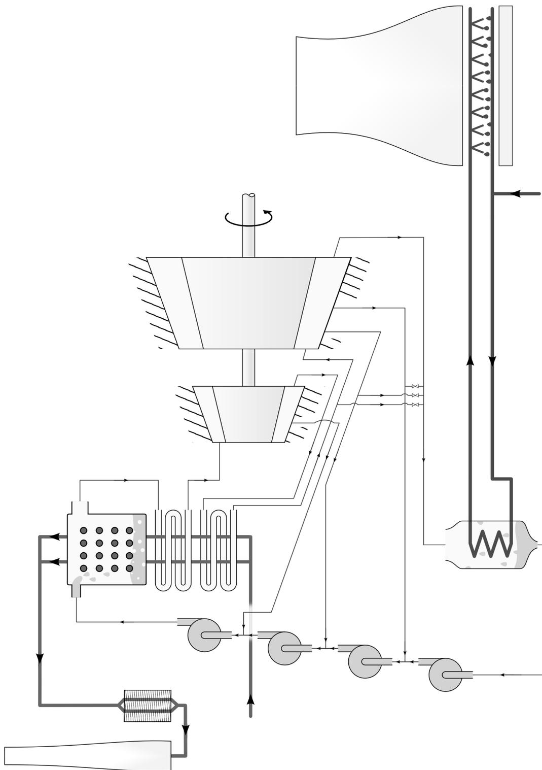
FIGURE 9.22 – Installation à vapeur mêlant surchauffé, resurchauffé, régénération, et conduits de décharge. Il est laissé à l'étudiant/e curieux/se le loisir de tracer les évolutions sur un diagramme température-entropie, et de s'imaginer aux commandes de l'installation alimentant sa cafetière en électricité.
