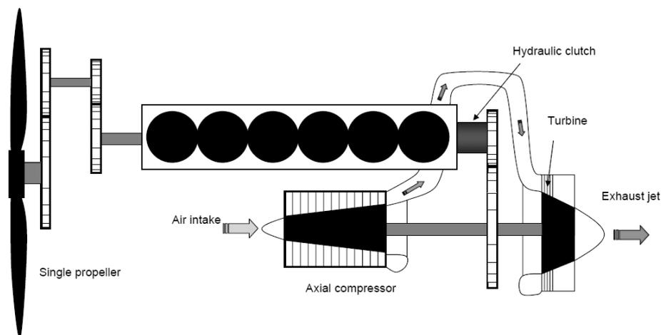
FIGURE 10.29 – Schéma de principe du circuit thermodynamique du *Napier Nomad II*. Un réducteur mécanique-hydraulique à rapport variable relie les deux ensembles, qui entraînent désormais la même hélice.
