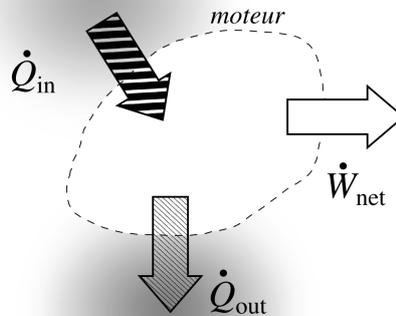
FIGURE 6.11 – Transferts énergétiques associés à un moteur. On souhaite obtenir un grand transfert  $\dot{W}_{\text{net}}$  (résultat) à partir du transfert  $\dot{Q}_{\text{in}}$  (coût). Le rejet  $\dot{Q}_{\text{out}}$  est indésirable.
