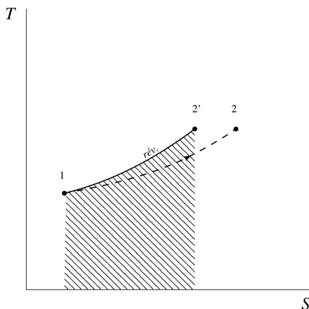
FIGURE 8.3 – Diagramme température-entropie. Lors d'une transformation réversible, l'aire sous la courbe d'un diagramme  $T - S$  représente la chaleur transmise  $Q_{1 \rightarrow 2'}$  ; mais pas lorsqu'elle est irréversible.
