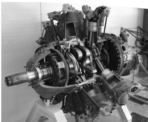
FIGURE 9.24 – Découpe d'un moteur *Pratt & Whitney Twin Wasp* (1932), montrant l'arrangement intérieur avec bielles et vilebrequins reliant les deux rangées de sept pistons agencés en étoile. Le moteur, de cylindrée 30 L, dégageait plus de 1 000 ch et a été produit à plus de 170 000 exemplaires.
