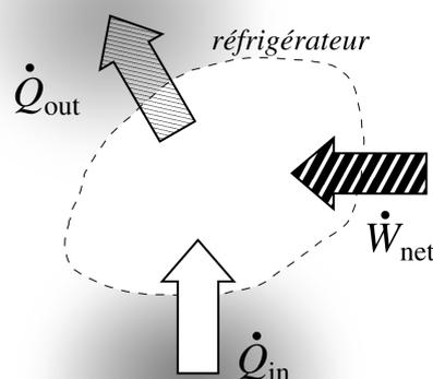
FIGURE 6.12 – Transferts énergétiques associés à un réfrigérateur ou à un climatiseur. On souhaite obtenir un grand transfert  $\dot{Q}_{in}$  (résultat) à partir du transfert  $\dot{W}_{net}$  (coût).
