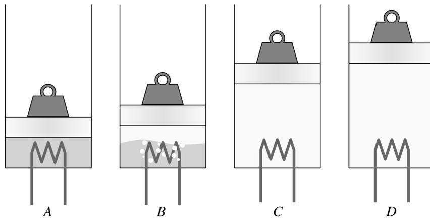
FIGURE 5.4 – Réchauffement d'une quantité fixe d'eau à pression constante.
