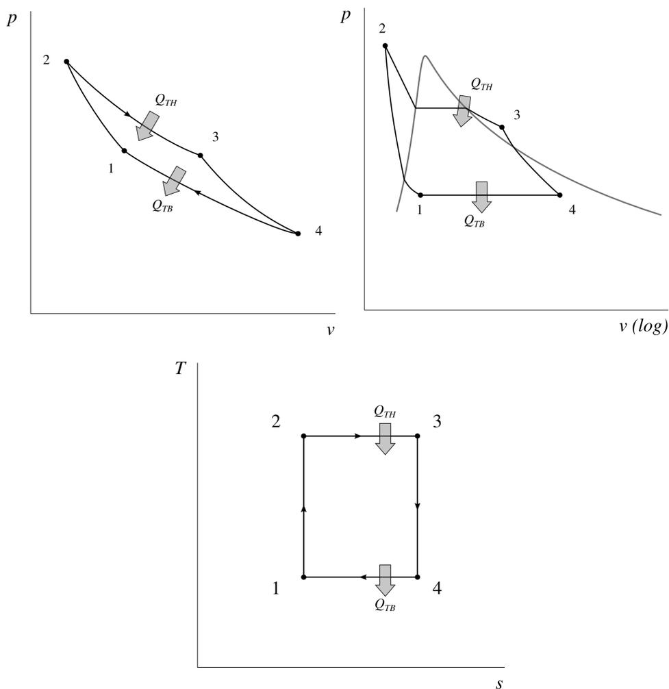
FIGURE 8.6 – Cycle moteur de Carnot, sur un diagramme  $p - v$  pour un gaz parfait (gauche), sur un diagramme  $p - v$  pour un liquide-vapeur (droite), et sur un diagramme  $T - s$  (bas). Quel que soit le fluide utilisé, le diagramme température-entropie reste le même.
